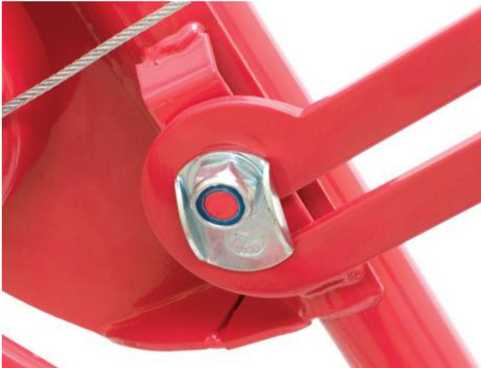
Le verrou de barre coulissante retient le treuil dans sa position de travail (complètement étendu). Pour replier le treuil contre le châssis (en démontant l'unité pour le transport ou le rangement), désengager le verrou en le tournant dans le sens antihoraire tout en levant la barre coulissante. Quand vous réassemblez l'unité pour les opérations, étendre complètement le treuil puis le repousser légèrement en arrière vers le châssis, ce qui engage automatiquement le verrou.
