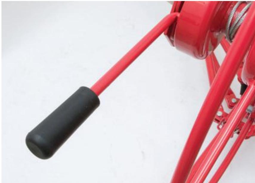
Un frein à ressort maintient le berceau à la hauteur désirée quand il est levé avec le treuil. Pour abaisser le berceau, contrôler la rotation du treuil en tenant la poignée de volant tout en levant doucement le levier de frein pour le relâcher.
