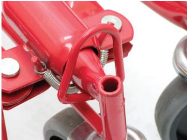
Appuyer sur l'anneau d'empêchement vers le bas pour déverrouiller les deux pieds avant pour puissent pivoter vers la position de travail A de l'engin de levage jusqu'à engager la goupille sur ressort dans un orifice en bas du tube coulissant, afin de verrouiller les pieds pliables en position.
